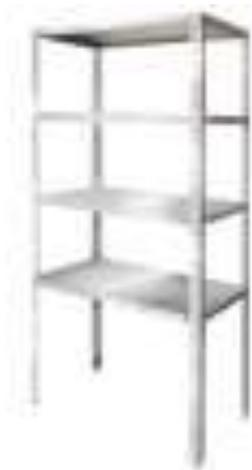
Стеллаж на каркасе из нержавеющей уголка со сплошными полками имеет разборную конструкцию. Полка выдерживает распределенную нагрузку до 200 кг. Максимальная распределительная нагрузка на стеллаж не более 800кг (при комплектации стеллажа четырьмя полками). Ножки стеллажа регулируются по высоте.
