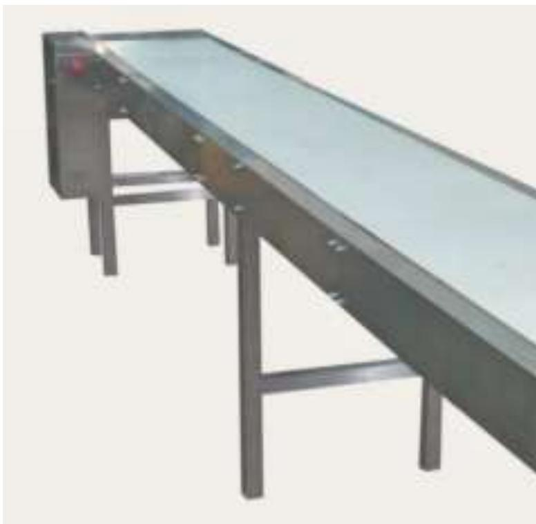
В изделии применена бесконечная конвейерная лента импортного производства, состоящая из тканевого основания, верхнего слоя из ПВХ и одной тканевой прокладки. Ширина ленты транспортера 400 мм, толщина 2 мм.
